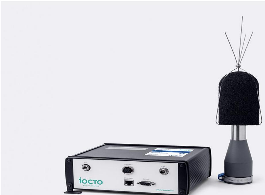
Nebensiehendes Bild zeigt beispielhaft die wesentlichen Baueinheiten (Messmikrofon und Datenverarbeitungseinheit) der von der Lärmschutzgemeinschaft Flughafen Köln/Bonn benutzten Lärm-Messanlagen (Herstellers IOCTO GmbH) deren Schallpegelmessungen gemäß DIN EN 61672 erfolgen
